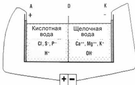
Принципиальная схема ионизатора воды
