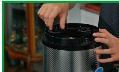
4. Открутите пробку резервуара. Придерживая одной рукой резервуар, поверните пробку против часовой стрелки до разъединения.
