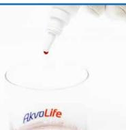
Накапайте в воду 4-5 капель из флакона с реагентом. Затем хорошо размешайте содержимое стакана до однородного состояния;
