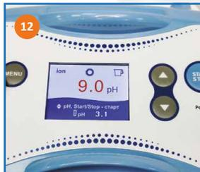
Через несколько секунд на дисплее отобразится последний выбранный уровень pH (к примеру pH 9.0). Установленный уровень pH запоминается прибором и может быть использован в следующий раз. Достаточно нажать на кнопку «START/STOP», чтобы приготовить воду с тем же уровнем, что и в прошлый раз.
